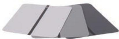
Металлическая загрунтованная пластина размером 105x150 мм с полосой для тестирования автомобильных красок.
