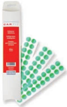
Стикер для парковочного сенсора представляет собой полиэфирную пленку с нанесенным на нее термостойким клеевым слоем. Клеевой слой на основе кремнийорганики защищает парковочный сенсор в процессе ремонта, предотвращая повреждения от шлифования, окраски и полировки. Это экономит время и снижает риск от возможных проблем или неисправностей сенсоров, которые могут возникнуть в процессе ремонта автомобиля. Клеевой слой защищен протектором.
