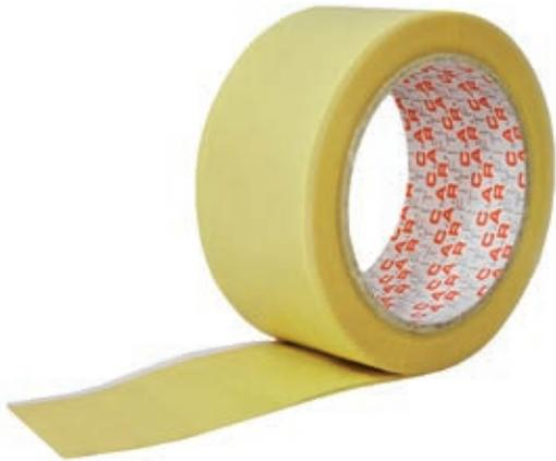
Подъемная лента изготовлена из термостойкой креповой бумаги с клеевым слоем. Лента имеет перфорацию, что делает ее удобной и простой в использовании. Высокая гибкость позволяет без труда наклеивать ленту на детали с контуром любой сложности. Используется для маскировки резиновых частей и боковых молдингов в процессе ремонтной окраски. Без протектора.
